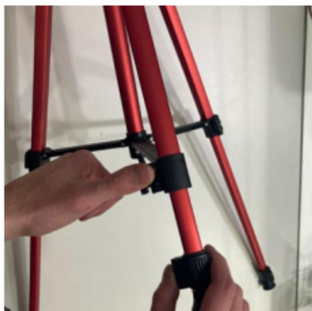
1) Alargar cada pata del trípode para que quede a la altura deseada.
