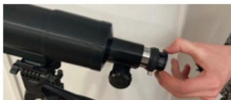
**10)** Sacamos la tapa del enfocador y colocamos el espejo cenital por la parte metálica
