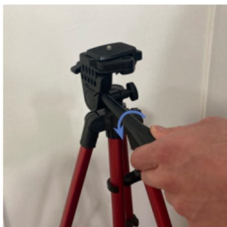
3) Aflojar la perilla larga de rotación azimutal para ajustar más adelante.
