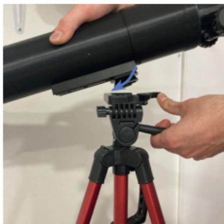
7) Anclar telescopio en diagonal, abriendo la palanca de la placa de sujeción
