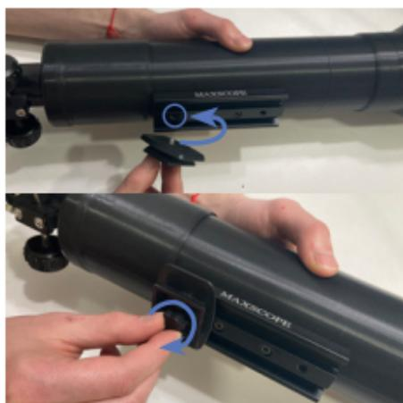
6) Atornillar tornillo de 1/4" de la placa de sujeción a la barra Vixen universal.
