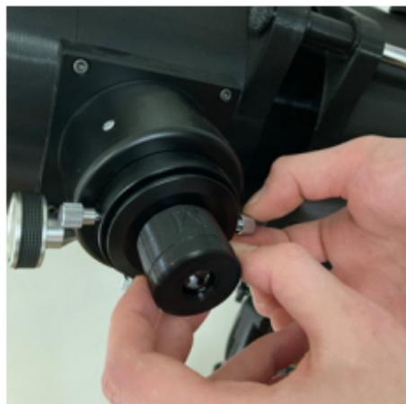
Con el ocular dentro, ajuste el tornillo derecho del enfocador para dejarlo inmóvil.
