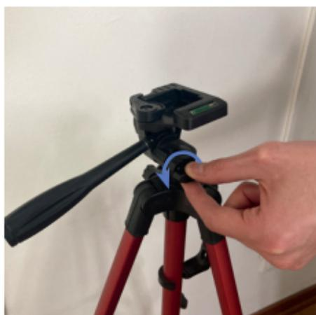
2) Aflojar la perilla que sujeta el cabezal y dejarlo libre para rotar.
