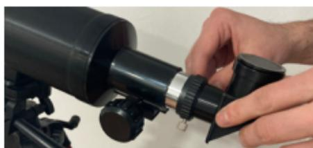
**11)** Una vez colocado el espejo cenital, se ajustan los pernos para sujetarlo.
