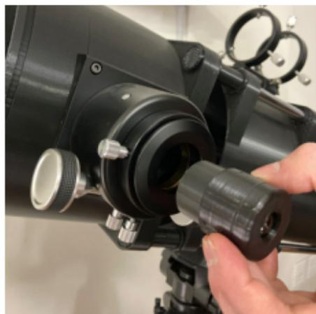
Retirar la tapa de silicona del enfocador, luego coloque el ocular deseado (2" o 1.25").
